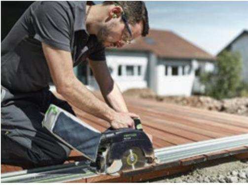
**Un guidage précis :** la HKC 55 prouve sa polyvalence avec le système de rails de guidage Festool.
