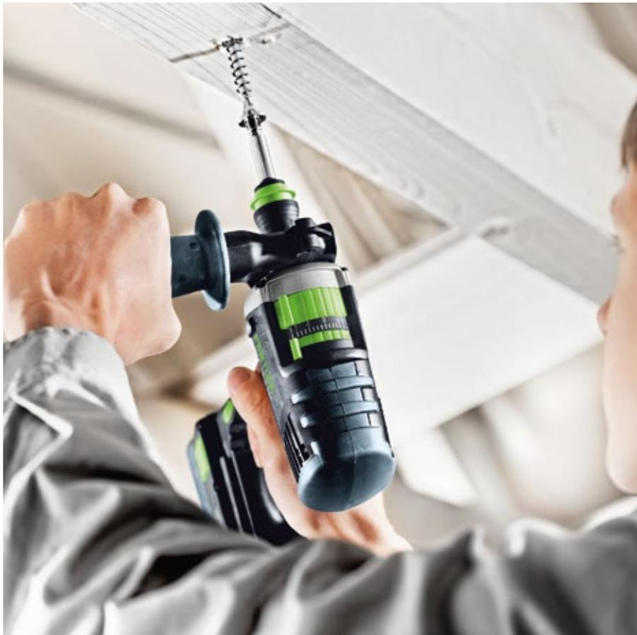
**60 Nm en 1ère vitesse :** la perceuse-visseuse QUADRIVE DRC visse facilement des vis à bois jusqu'à 10/12 mm de diamètre. La PDC, quant à elle, est dotée d'une frappe axiale activable pour le perçage dans les ouvrages de maçonnerie.
