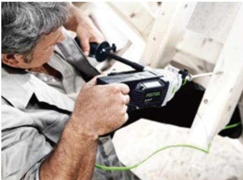
**Conçue pour de grandes missions :** perceuse-visseuse QUADRILL DR 20 pour les vis à bois jusqu'à 10/12 mm de diamètre ou des perçages jusqu'à 65 mm. Configurable rapidement avec différentes fonctions via l'interface FastFix.
