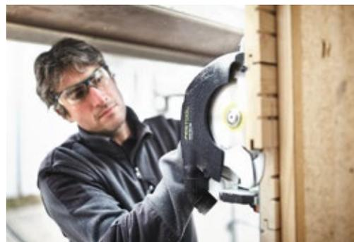
**Puissante, exacte, polyvalente** : la scie circulaire à capot basculant sans fil HKC 55 en combinaison avec le rail de guidage FS
