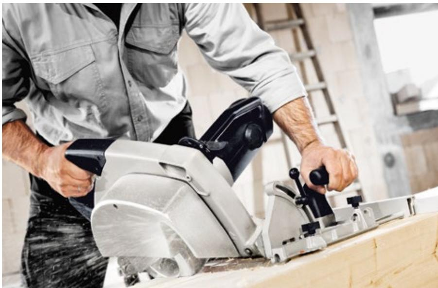
**Retirer la lame de scie et placer le bloc à moiser :** la scie circulaire portable HK 132 E se transforme, grâce au dispositif de bloc à moiser, en une fraise à moiser fiable.
