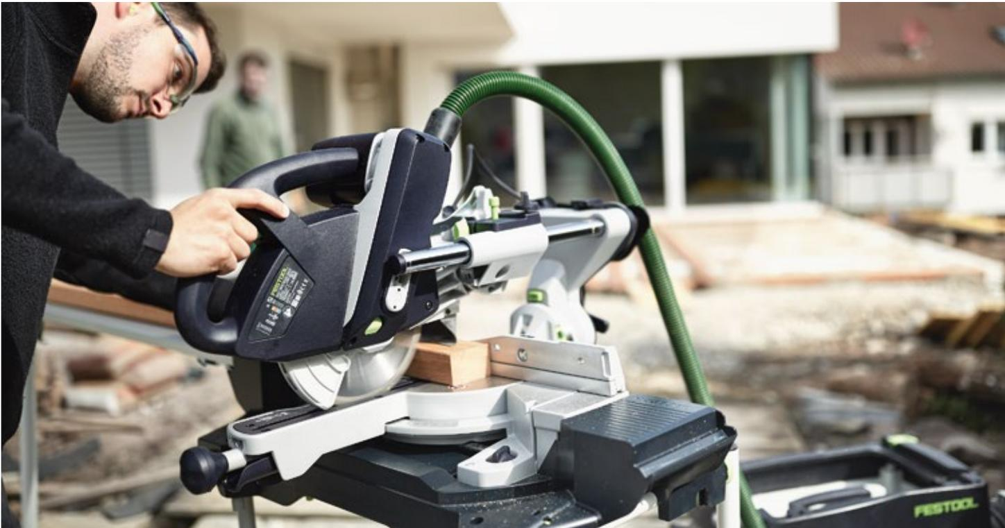
**Double précision :** grandes dimensions et montage sur deux roulements à billes. Le guidage à double colonnes Festool permet un guidage fiable de la lame, garantissant une précision maximale.
