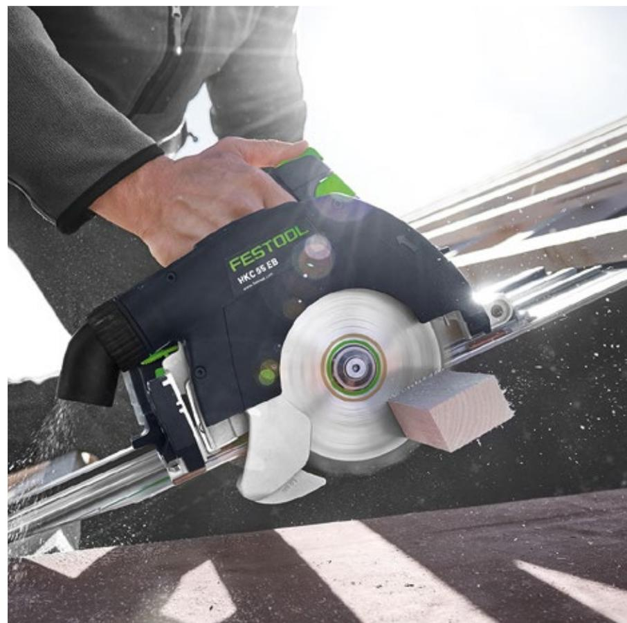
**Pour plus de mobilité dans la construction bois :** la scie circulaire à capot basculant sans fil HKC 55, avec rail pour coupes d'onglet FSK, illustre ce dont une scie est capable de réaliser sur un toit.
