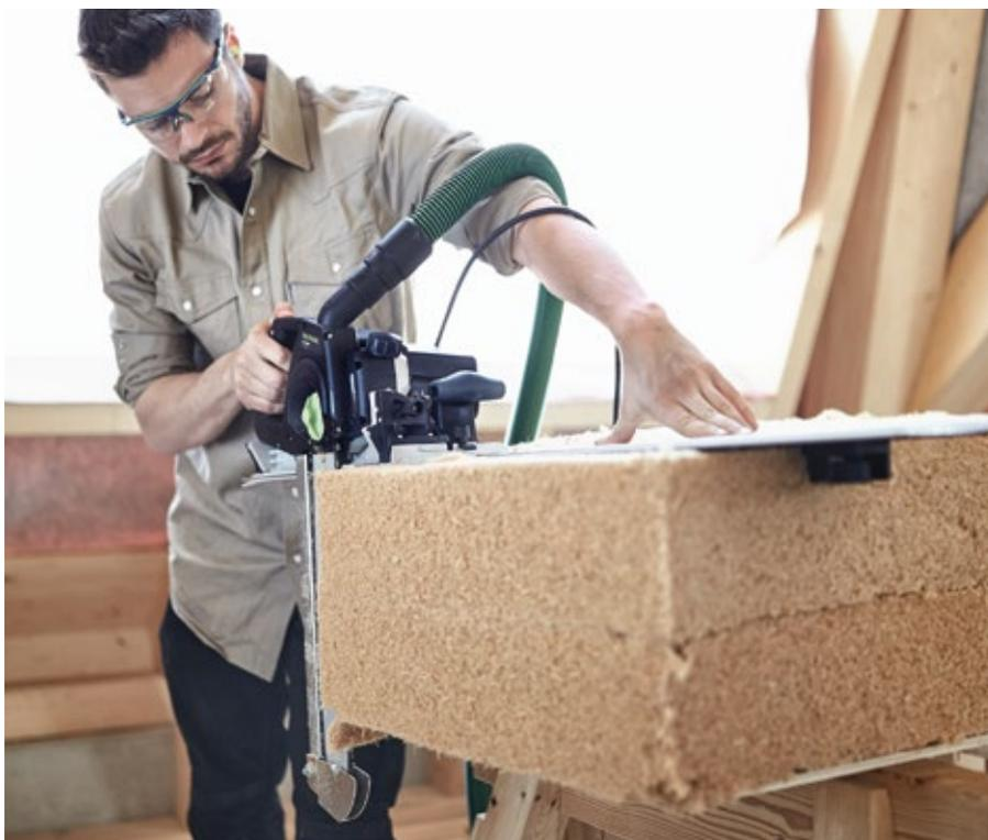
**Une découpe facile des matériaux d'isolation :** la scie IS 330 combine les avantages d'une scie à chaîne et d'une scie circulaire portable pour constituer un système mobile sans précédent. Avec une profondeur de coupe de 330 mm et une plage de pivotement de 60°, elle convient pour des coupes d'onglets extrêmes avec des profondeurs de coupe de 230 mm à 45° et 165 mm à 60°.
