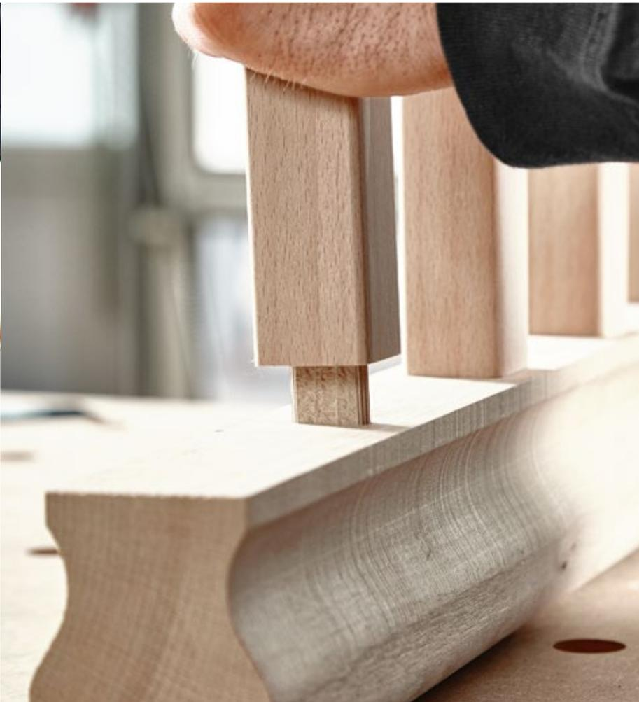
**Une fois réglé, vous pouvez travailler en série** : avec le gabarit multi-fraisage MFS et la défonceuse OF 2200, les limons d'escaliers sont vite fraisés.
