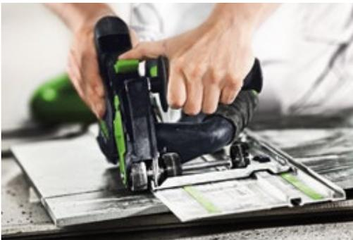
**Guidage précis, travail propre :** système de tronçonnage diamant DSC-AG avec rail de guidage pour la découpe précise de panneaux de façade – environnement de travail sans poussière avec l'aspirateur
